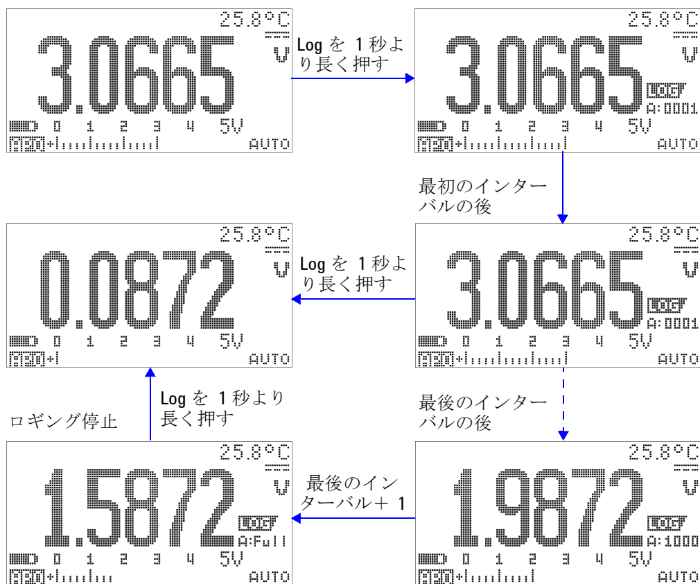
図 3-10 インターバル (タイム) ロギング・モードの動作
